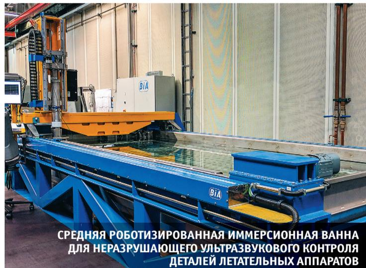
СРЕДНЯЯ РОБОТИЗИРОВАННАЯ ИММЕРСИОННАЯ ВАННА ДЛЯ НЕРАЗРУШАЮЩЕГО УЛЬТРАЗВУКОВОГО КОНТРОЛЯ ДЕТАЛЕЙ ЛЕТАТЕЛЬНЫХ АППАРАТОВ
