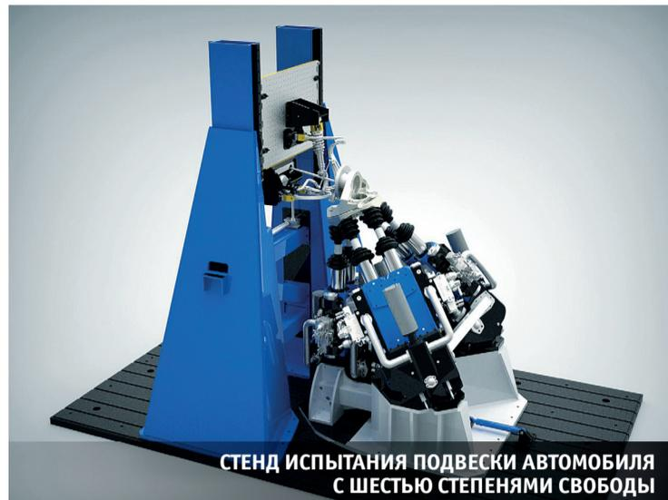
СТЕНД ИСПЫТАНИЯ ПОДВЕСКИ АВТОМОБИЛЯ С ШЕСТЬЮ СТЕПЕНЯМИ СВОБОДЫ
