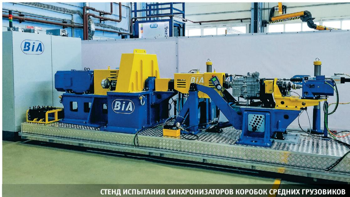
СТЕНД ИСПЫТАНИЯ синхронизаторов коробок средних грузовиков
